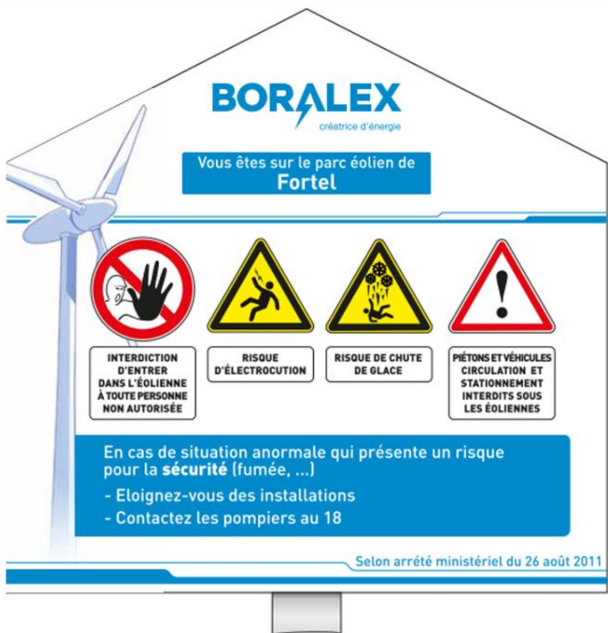
Figure 2 : Panneau type d'avertissement à l'entrée des plateformes des éoliennes (exemple)
